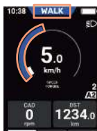
Mode d'assistance à la marche (en fonctionnement)
