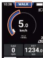
Loopondersteuningsmodus (functie voor loopondersteuning)
